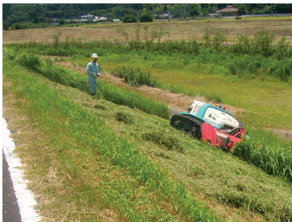
写真 2.1.5 大型遠隔操縦式草刈車による 除草状況
